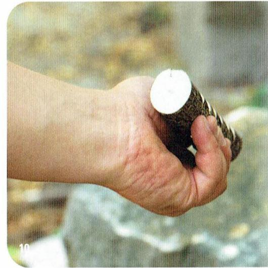
Anschließend wenden Sie das Holz und wiederholen den Arbeitsschritt von der anderen Seite. So entsteht der Rillenkamm (6, 7). Wie schon erwähnt, ist ein ausreichend großer, sicherer Griff bei diesem Arbeitsschritt sehr von Vorteil.
